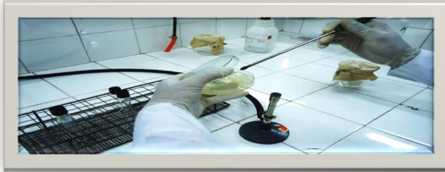
FOTO N° 8: Sembrío de las bacterias en forma de estrías y su incubación de 36 a 37 °C por 24 horas
