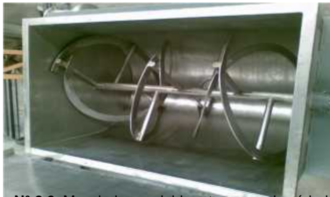
Fig. N° 2.6. Mezcladora a doble artesa con dos árboles
