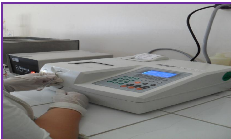
FOTOS N° 10. LECTURA EN EL ESPECTROFOTOMETRO
