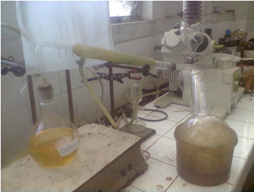
IMAGEN 8:El filtrado se concentra en rotavapor y se destila en el destilador.
