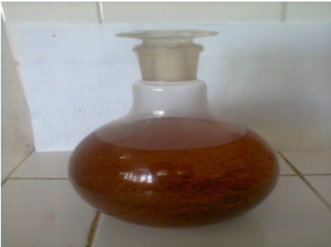
IMAGEN 5: Balón concentrado con alcohol etílico y se extrae con éter de petróleo.
