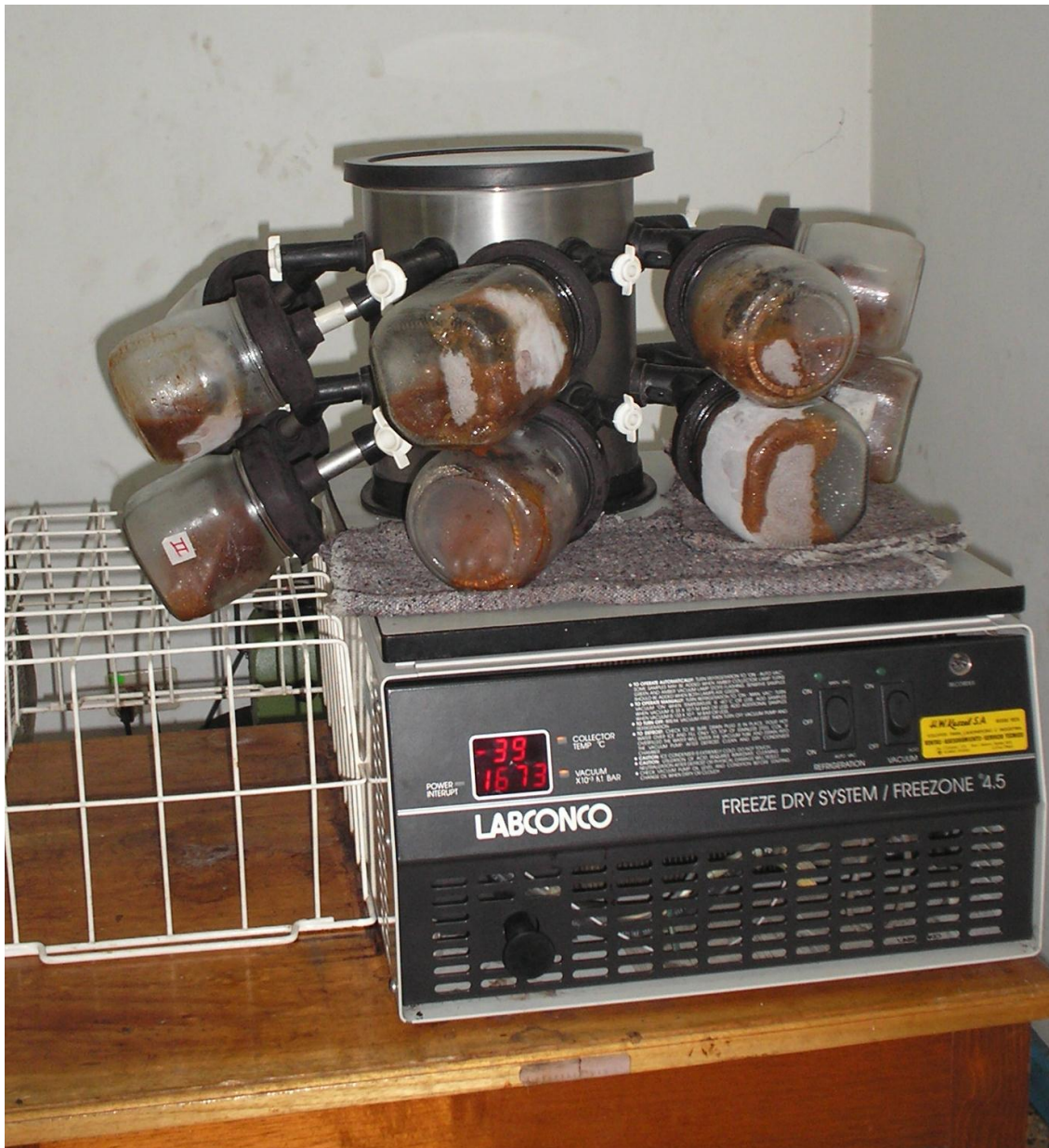
FOTO Nº 11: Proceso de liofilización del extracto acuoso de las hojas de Clibadium surinamense L. (huaca) realizados en un liofilizados Freezer Dry sistem 4,5 L LABCONCO del laboratorio de Fitoquímica del IMET-EsSalud.
