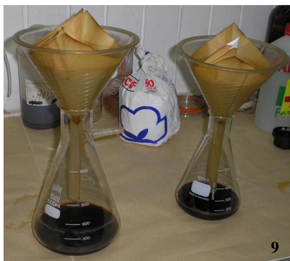
FOTO Nº : FOTO Nº 08-10: Proceso de filtrado y obtención del extracto acuoso de la hojas de Clibadium surinamense L. (huaca) realizados en el laboratorio de Fitoquímica del IMET-EsSalud.
