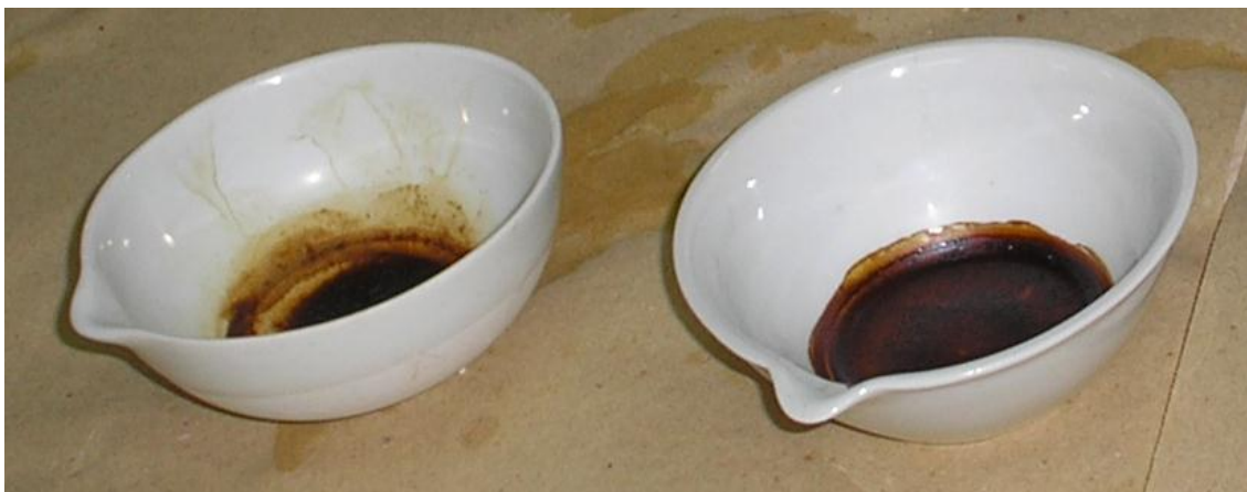
FOTO Nº 12: Proceso en la cual se esta determinado los sólidos totales de las hojas de Clibadium surinamense L. (huaca) realizados en el laboratorio de Fitoquímica del IMET-EsSalud.
