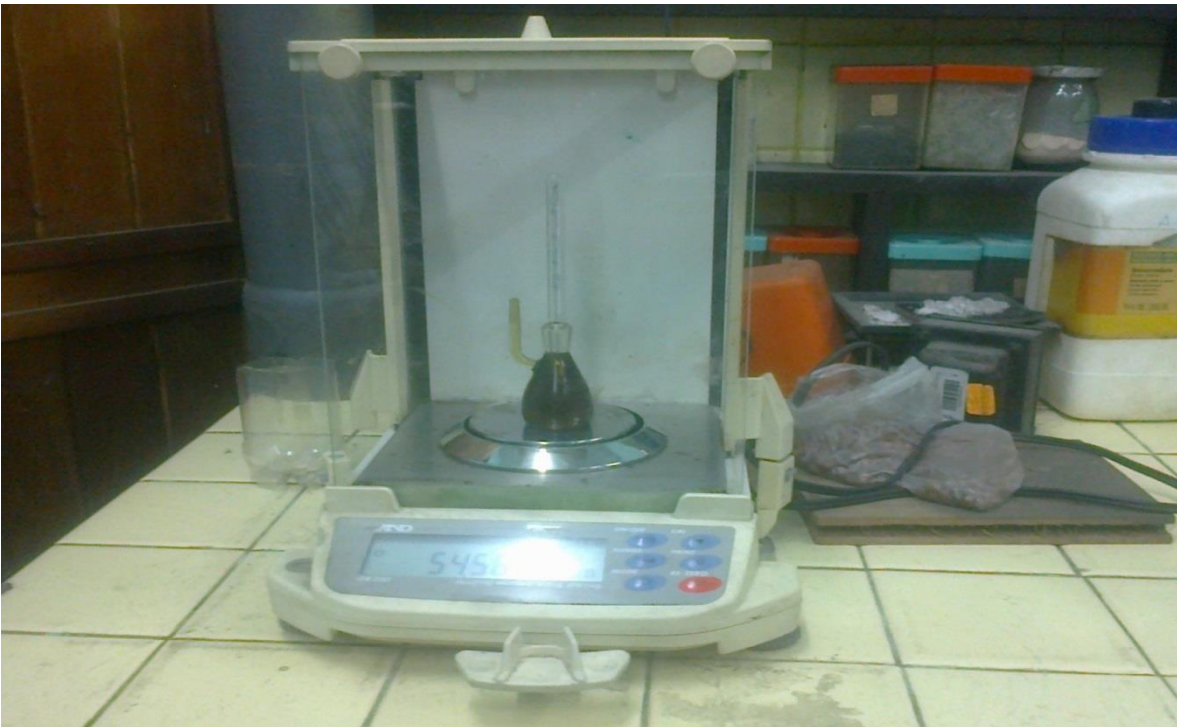
Figura N°16. Pesando el picnómetro más el aceite esencial
