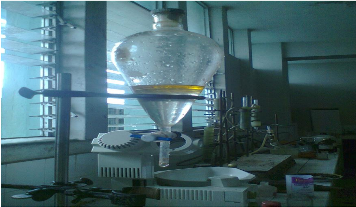
Figura N°14. Separando el sulfato de sodio anhidro del aceite esencial.
