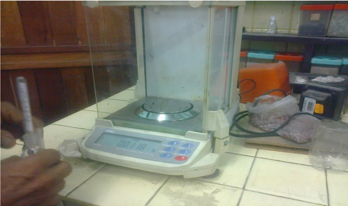
Figura N°16. Pesando el picnómetro más el aceite esencial
