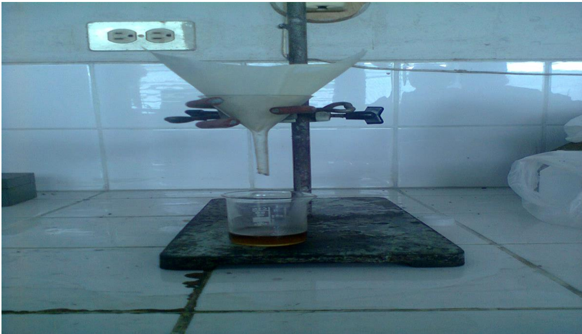
Figura N°14. Separando el sulfato de sodio anhidro del aceite esencial.
