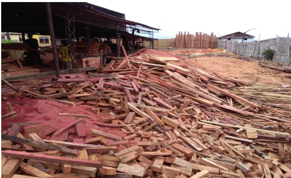
Figura 13. Desperdicios producidos por el proceso de aserrío en el aserradero Forestal Agrícola y Servicios el Tigre
