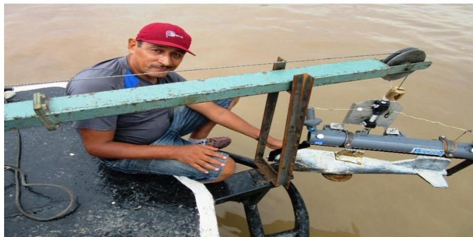
Foto N° 2. Calibración de los equipos, acoplamiento de la botella de Niskin
