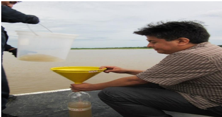
Foto N° 5. Transferencia de las muestras de sedimentos hacia el envase de plástico
