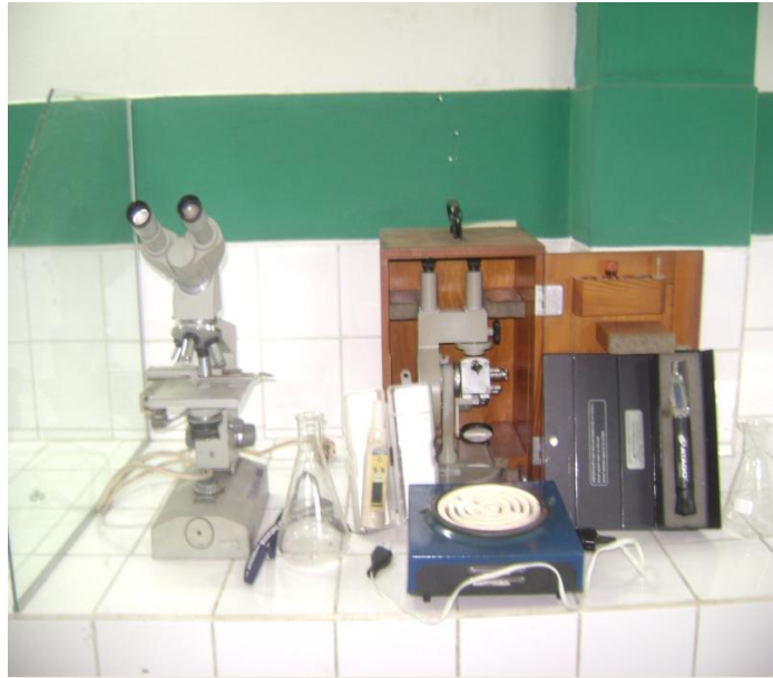
Foto N° 01: Equipos utilizados: Brixómetro, cocina eléctrica, refractómetro, pHmetro, microscopio.
