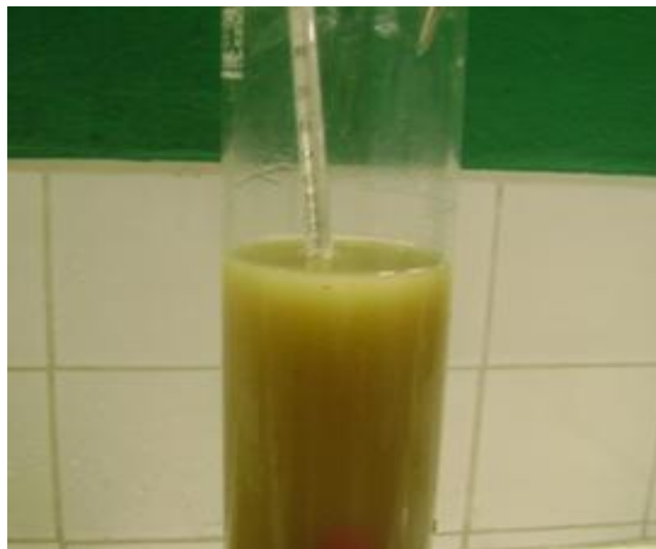
Foto N°12: Medición del grado alcohólico del mosto (en °G.L).
