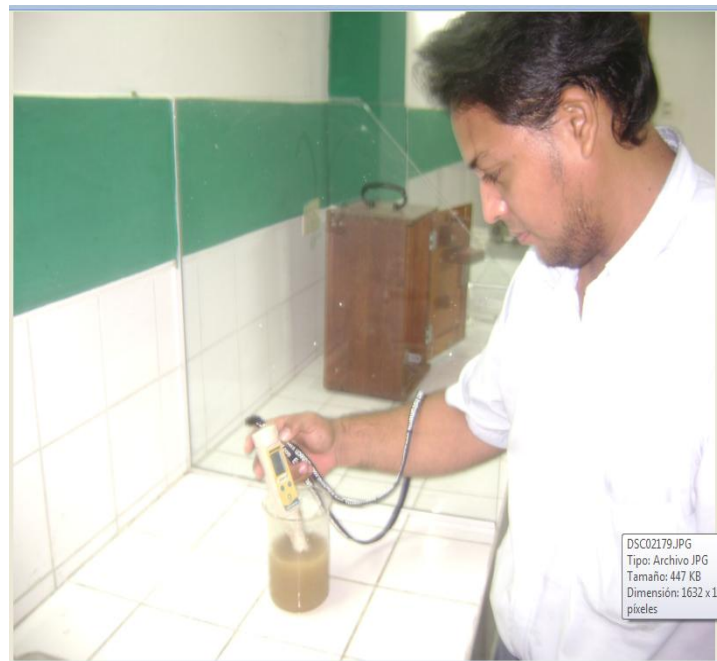
Foto N°10: Tesista realizando control del pH y temperatura.
