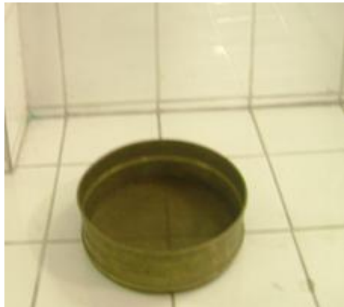
Foto N° 02: Malla metálica utilizada para filtración
