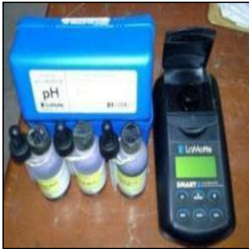
Figura 15: Equipo Colorímetro SMART 2 -LaMotte.
