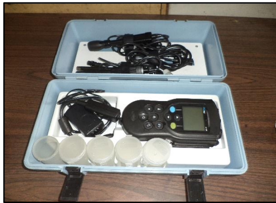
Figura 10. Multiparámetro YSI MODEL 57 utilizado para la medición de los parámetros de calidad de agua.
