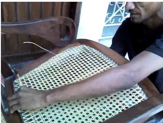
Anexo 9: Artesano tejiendo un mueble con las fibras de cashavara.
