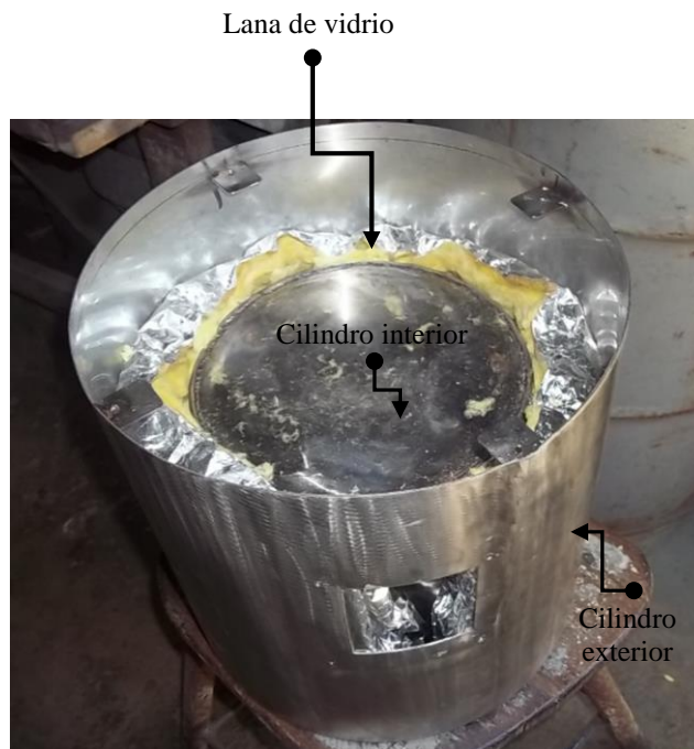
Figura 2.25. Espacio entre los cilindros interior y exterior, cubierto con lana de vidrio.
