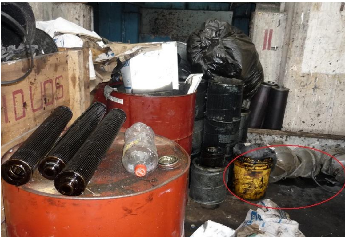
Fotografía 10: Almacenado inadecuado de filtros usados, presenta derrames y contaminación en el suelo como se puede observar en el círculo rojo
