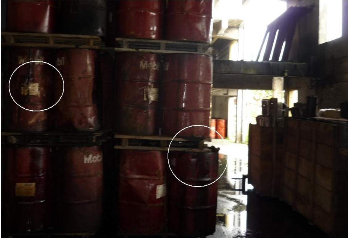
Fotografía 09: Barriles con residuos líquidos de hidrocarburos diferentes, con derrames como se puede observar en los círculos blancos
