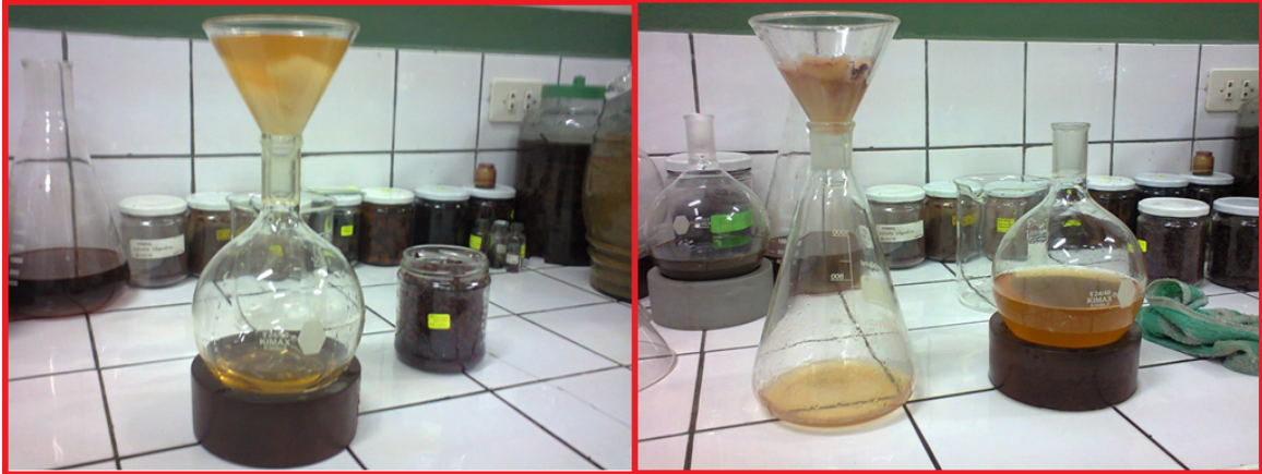
Foto N° 03. Proceso de filtrado de los extractos acuoso y etanólico del tallo de Brosimum rubescens “Palisangre” realizados en el laboratorio de Laboratorio de Ingeniería y Microbiología de Alimentos de la Facultad de Industrias Alimentarias – UNAP
