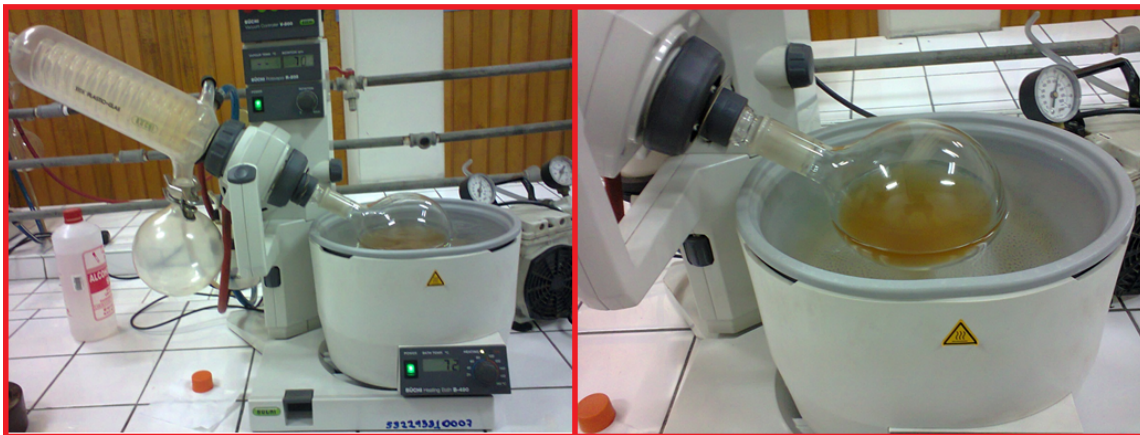
Foto N° 04. Proceso de extracción etanólica de los extractos vegetales del tallo de Brosimum rubescens “Palisangre” mediante utilización de rotavapor realizados dentro de las instalaciones del Laboratorio de Ingeniería y Microbiología de Alimentos de la Facultad de Industrias Alimentarias – UNAP
