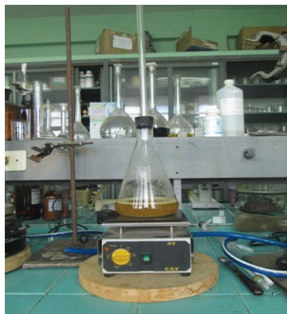
Fig. 16 : Digestión ácido- básico de muestra desengrasada.
