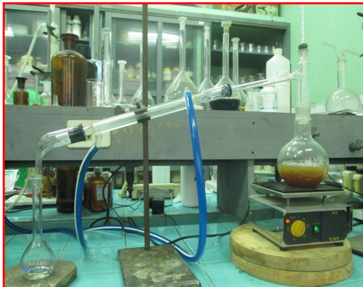
Fig. 27. Destilación del jarabe fermentado
