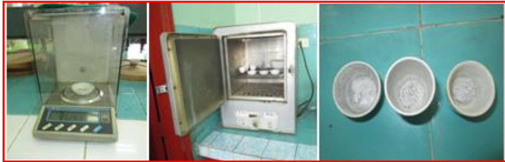
Fig. 13. Determinación de la humedad.
