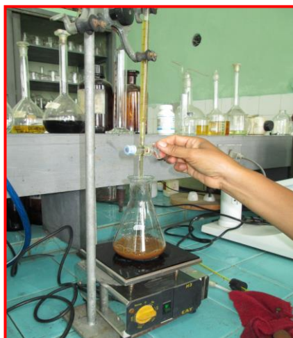
Fig. 19. Determinación de azúcares reductores
