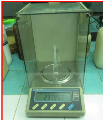
Fig. 28. Determinación del peso del picnómetro.
