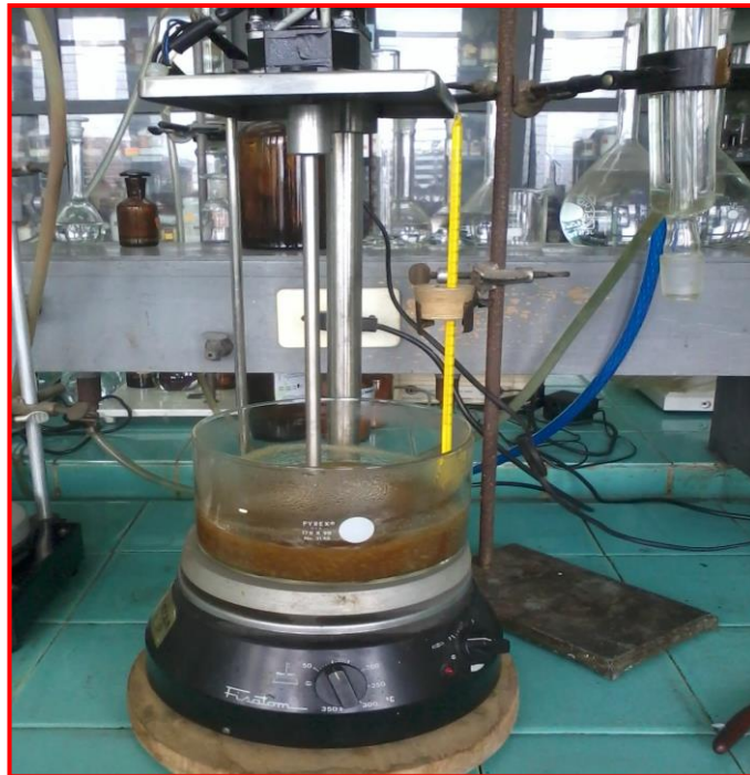
Fig. 21. Hidrólisis de la cascara de naranja y pomelo a T° 50 °C.
