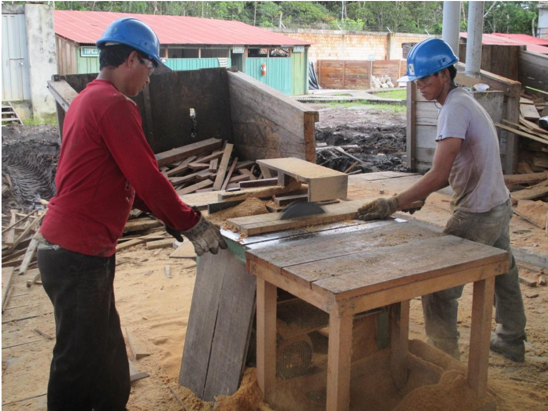
Figura 10. Sierra circular recuperadora de fabricación casera.
