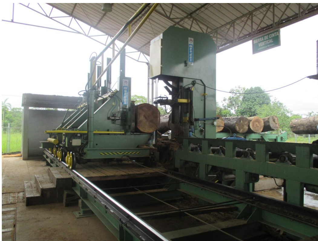
Figura 6. Sierra principal de sierra de cinta, marca Mendes, brasileña.
