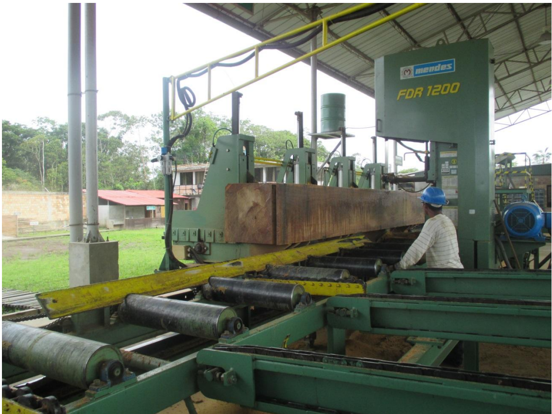
Figura 7. Reaserradora/tableadora de sierra de cinta, marca Mendes, brasileña.
