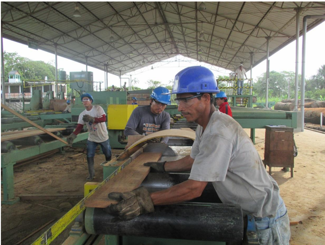
Figura 9. Sierra circular despuntadora, marca Mendes, brasileña.
