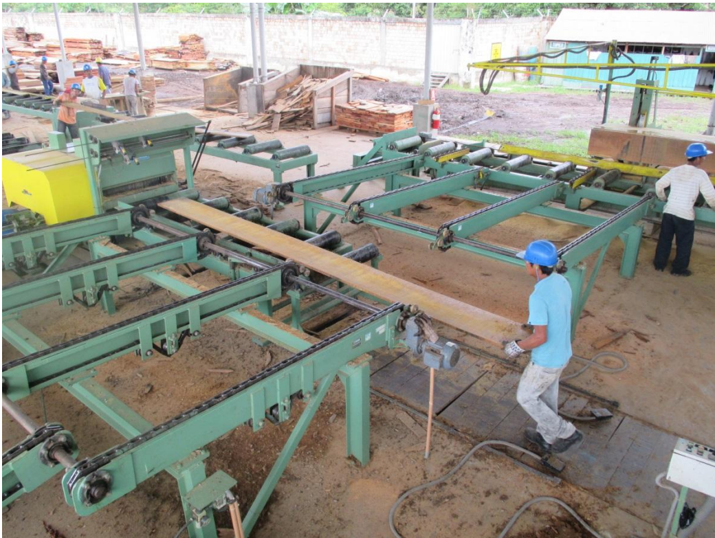
Figura 8. Sierra circular canteadora, marca Mendes, brasileña.
