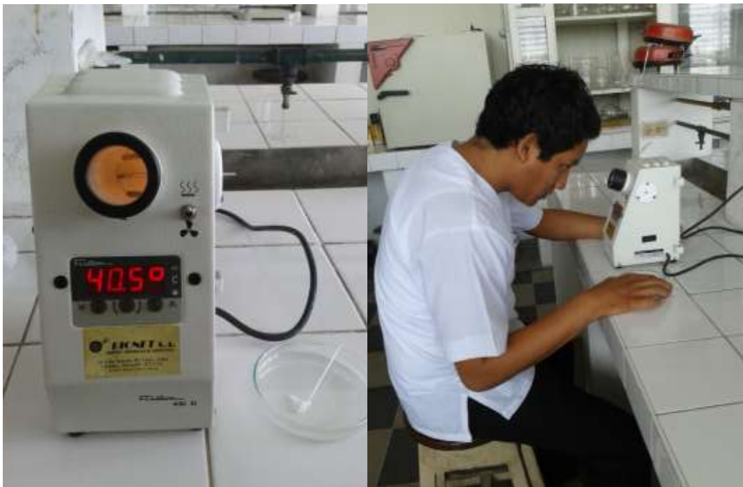
FOTO N° 16. Aparato Nalge Axelrod modificado (Derecha). Observación para análisis de Punto de Fusión (Izquierda).
