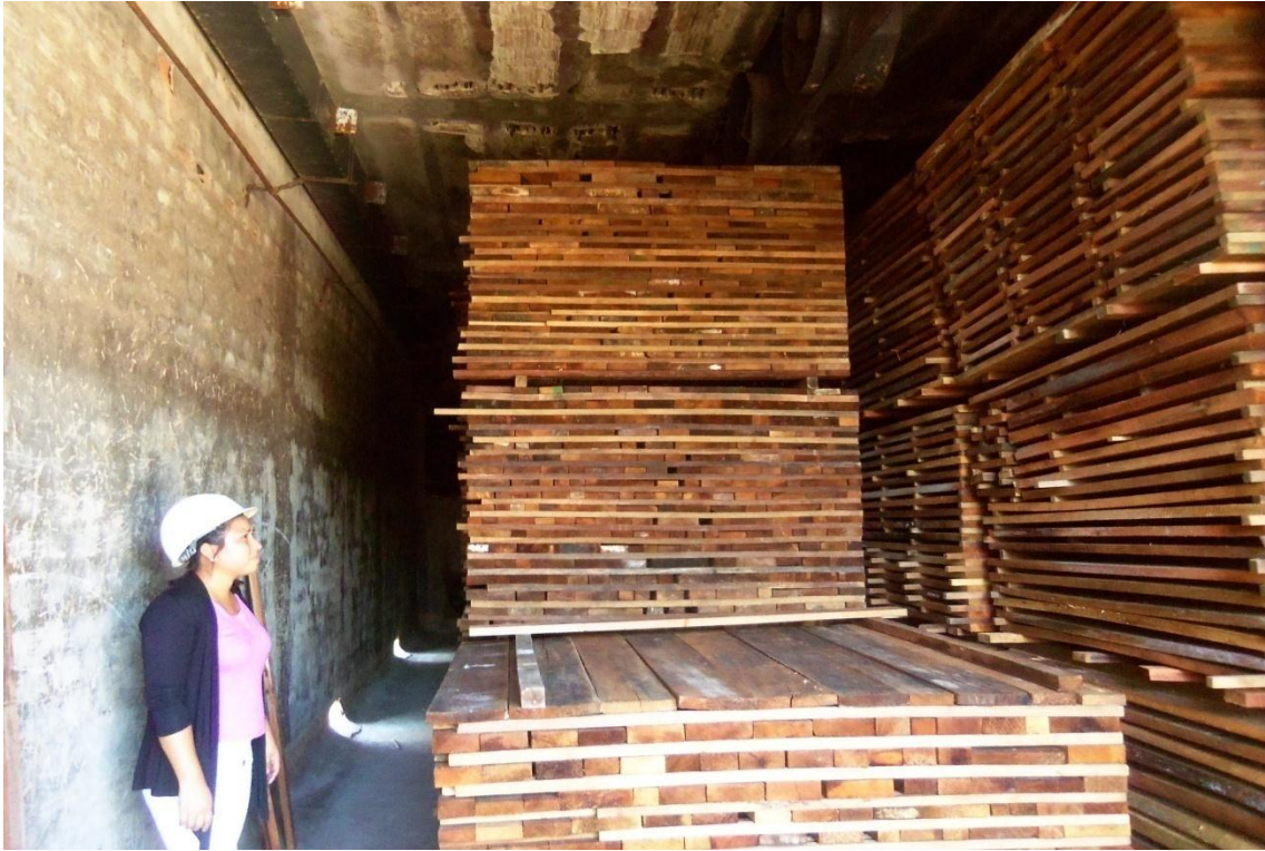
Figura 11. Inspección del llenado de la cámara
