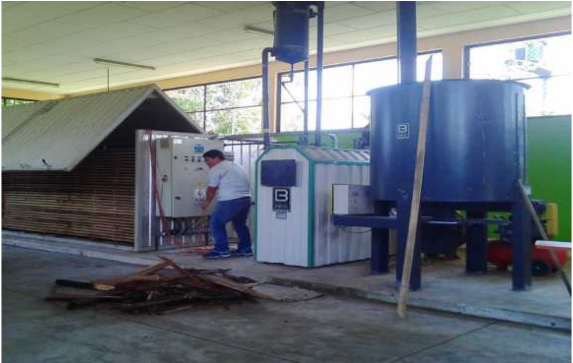
Figura 7: Encendido y manipulación del control de la cámara de secado
