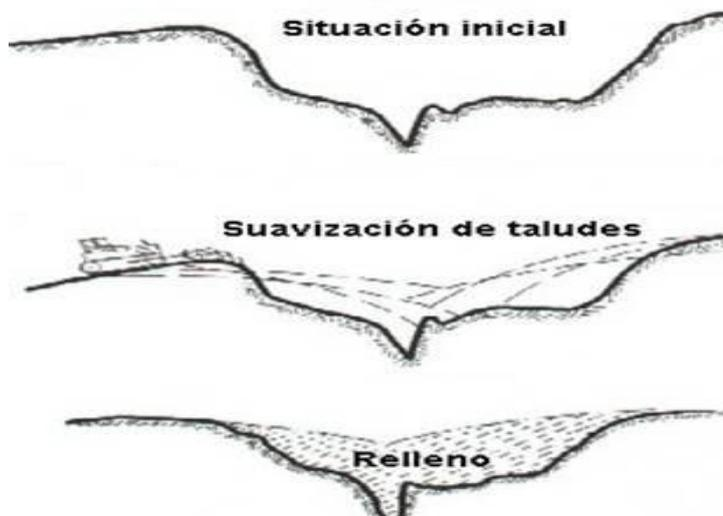
**Figura 4 Suavización de Taludes de Cárcavas con Maquinaria**
