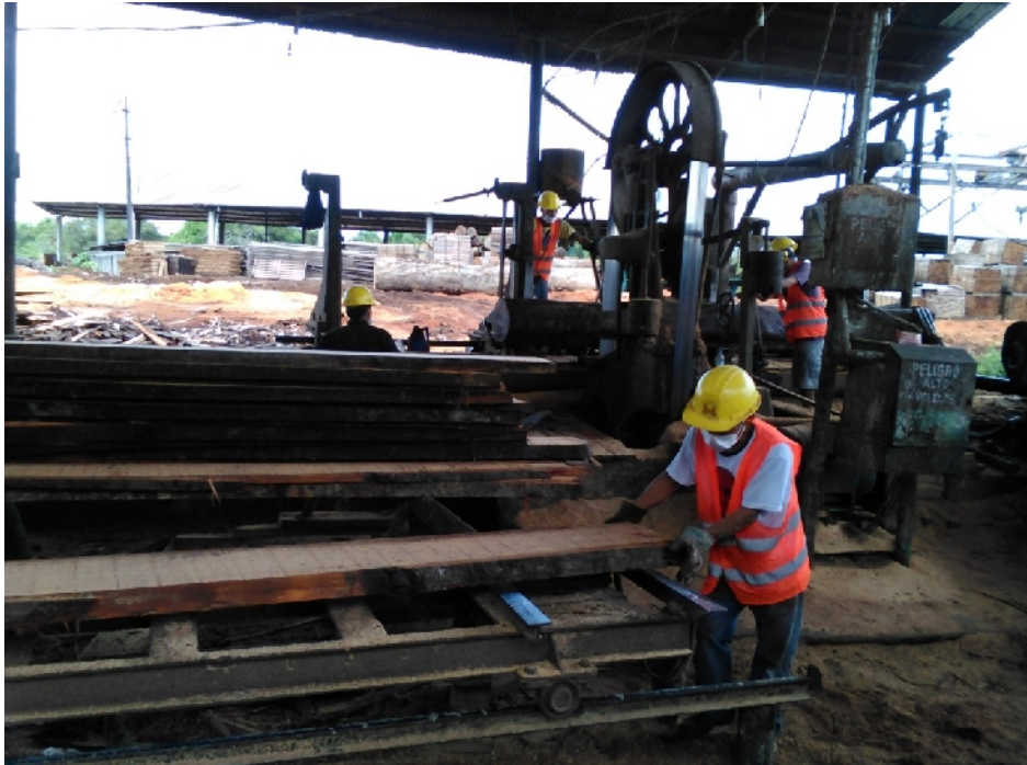
Figura N°07. Proceso de canteado del aserradero aserrío Raúl Oswaldo Oliveira García E.I.R.L.
