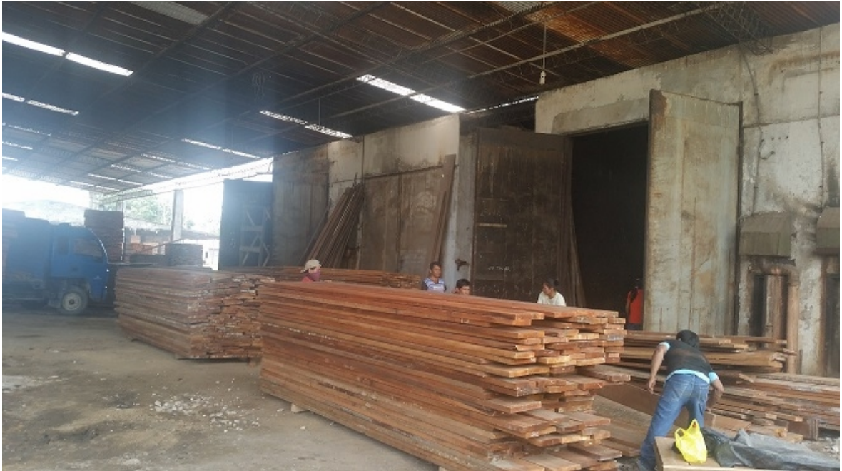
Figura N°15. Apilado para la cámara de secado en la empresa Zambito E.I. R.L.
