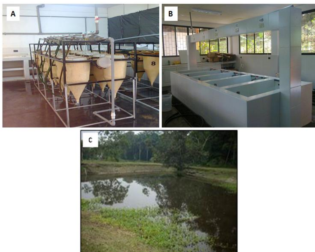
Figura 1.- Unidades de cultivo de peces del Centro de Investigación Quistococha - IIAP. A) Incubadoras cilindro cónicas, B) Tanques de concreto revestido con mayólica, C) Estanque de tierra.
