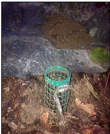
Figura 11. Punto de muestreo instalado en el suelo.
