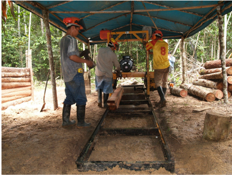
Figura 6: Aserradero portátil utilizado en la transformación de los árboles de la plantación 401 - 74
