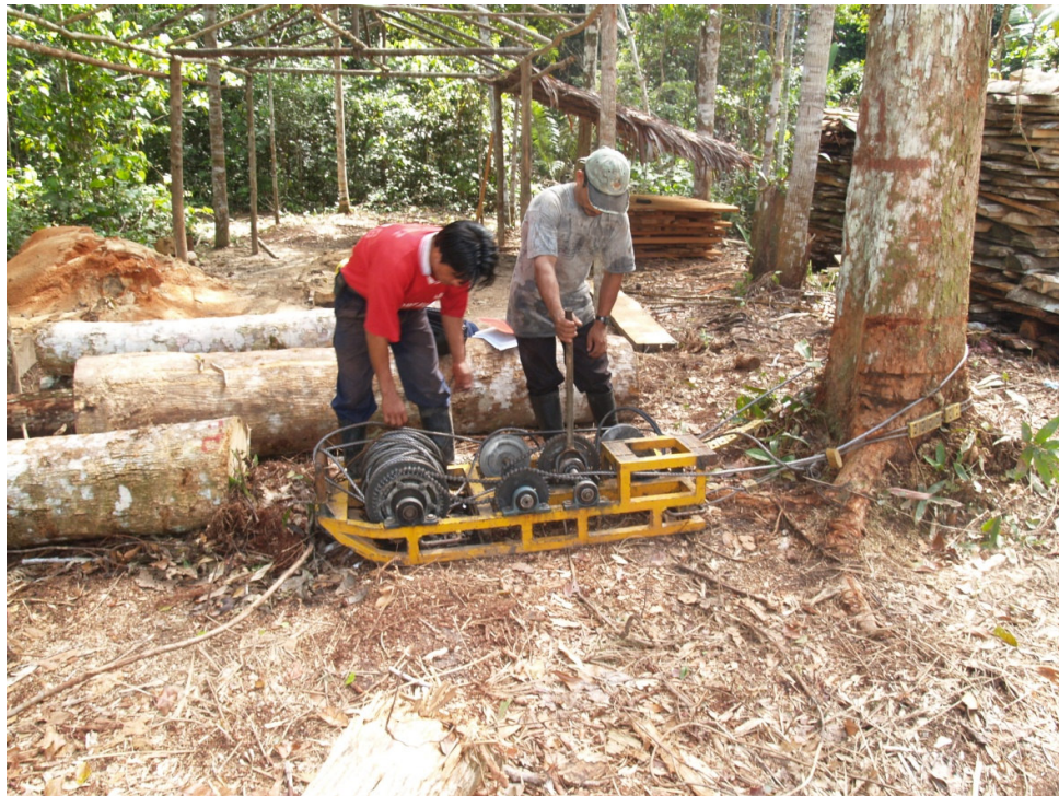
Figura 7: Winche utilizado para jalar las trozas de los árboles de la plantación 401 – 74.
