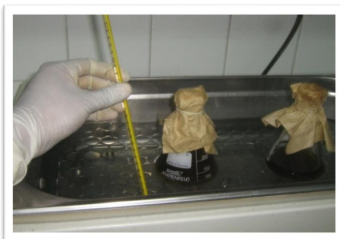
FOTO N° 05: Preparación de medios de cultivos. Agar Plate Count (Recuento estándar en placa) fue atemperado en baño María a 44-45°C antes de agregarlos a las placas petri.
