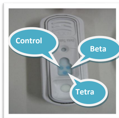
FOTO N° 20: Ejecución. Dentro de los 15 segundos de la muestra mezclada, se vertió todo el contenido del tubo de muestras en el pocillo de muestras del dispositivo SNAP.
