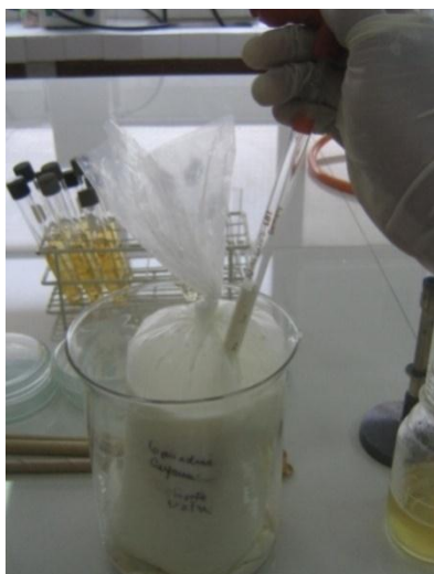
FOTO N° 06: Preparación del inóculo. Inoculación de las placas petri y tubos con una pipeta estéril 10 mL de muestra y se transfiere al frasco conteniendo 90mL de AP 0,1% para preparar la dilución 10^{-1} .
