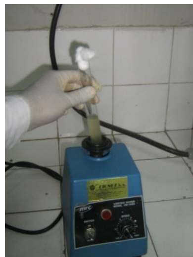
FOTO N° 07: Homogenización los tubos conteniendo 9mL. de AP y un 1mL de muestra por 20 segundos en el aparato vortex.
