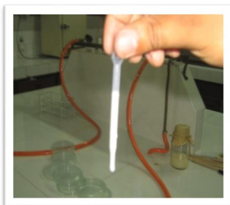
FOTO N° 19: Con la pipeta se extrajo la leche hasta la línea indicadora
