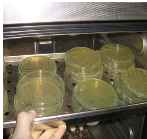
FOTO N° 13: Aislamiento de cultivos. Se siembra por estría en agar ENDO con asa de aro se incuba 24 hr a 37 °C y se traspasa por estría a agar nutritivo y se incubó por 24 hr a 37°C.
