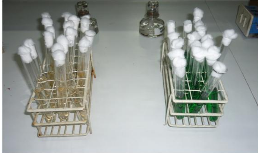
Tubos con caldo E. coli (izquierda) y tubos con caldo Brila (Derecha) en la fase confirmativa
