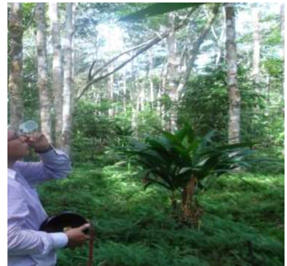
Ilustración 4. Medición de altura con clinómetro
