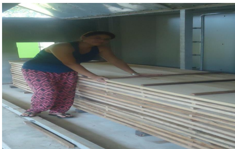
Figura 10. Posicionamiento adecuado de las ripas separadores.
