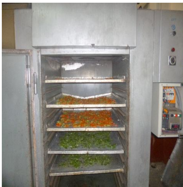
FIGURA N°7: INSUMOS EN EL SECADOR DE BANDEJAS DE AIRE CALIENTE
