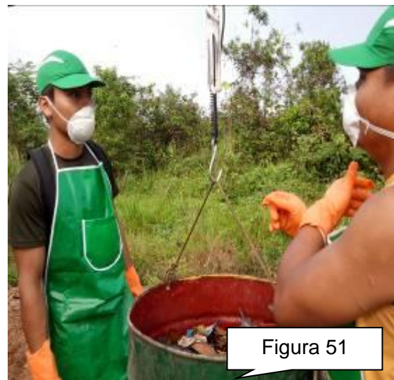
Figuras 50 y 51: Pesado del Cilindro con Residuos Sólidos.
