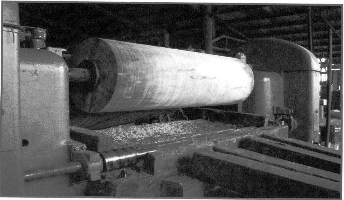
Foto N° 07: Boleado total de la troza en el torno.
