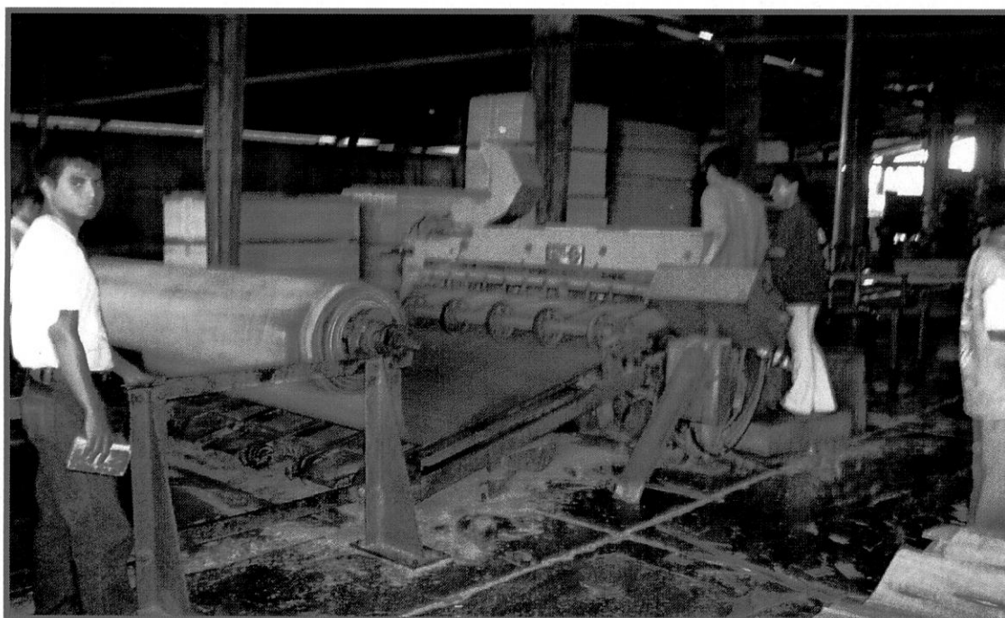
Foto N° 12: Carretes conteniendo sabanas de láminas para ser cortadas en la cizalla.
