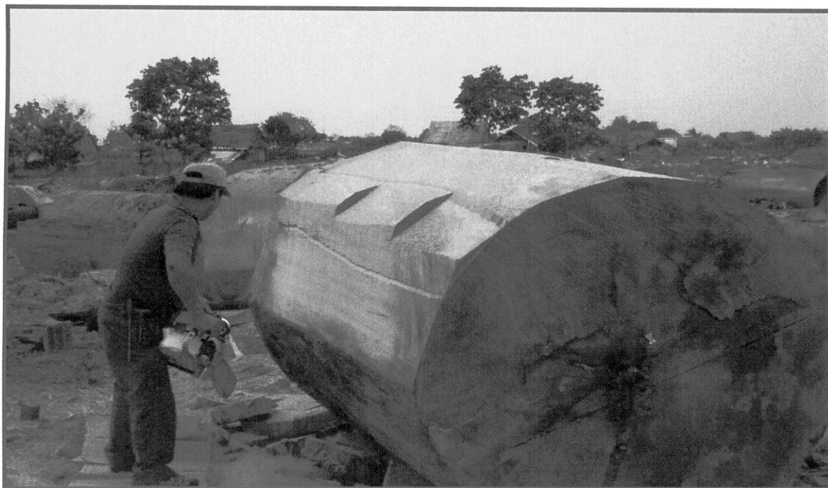
Foto N° 05: Operario aplicando el despuntado de la troza de Ceiba pentandra Gart.
