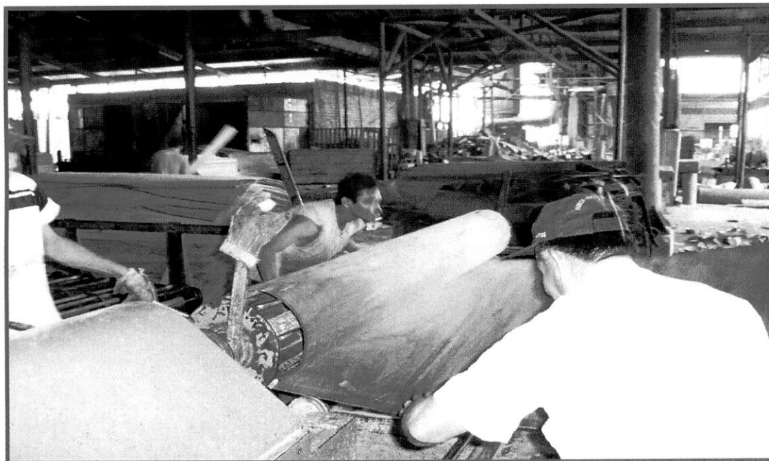
Foto N° 10: Rebobinado de láminas.
