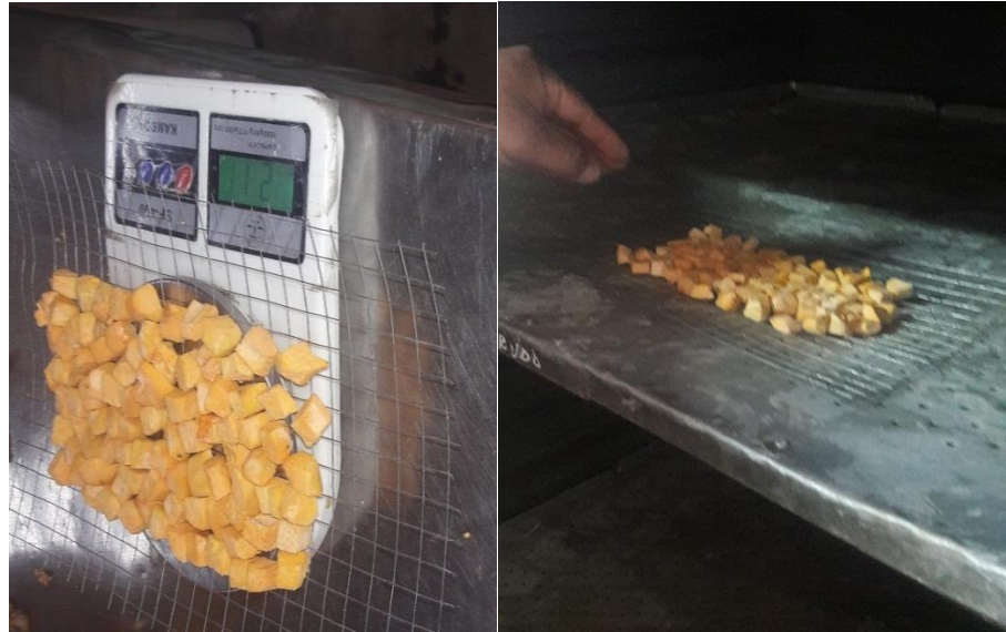
Figura N° 17: Muestras dentro del horno secador de bandejas.
