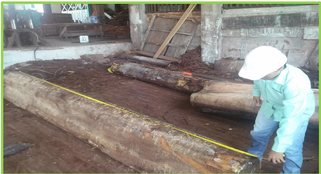
Figura 14. Cubicación de la troza certificada de la especie “marupa” Simarouba amara Aubl. proveniente de la concesión en la empresa forestal INVERSIONES LA OROZA S.R.L
