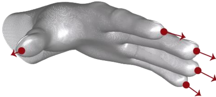
Figura 12 Finger TipPosition y de dirección vectores proporcionan la posición de la punta del dedo y la dirección general en la que un dedo está apuntando.
