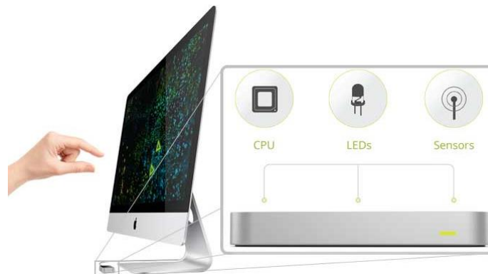
Figura 7. Funcionamiento y arquitectura de Leap Motion fuente:(Leap Motion, 2015)
