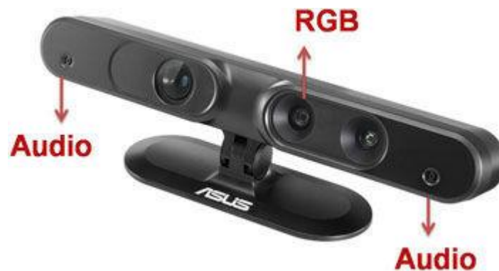
Figura 6 Xtion estructura. Fuente: (ASUS, 2013)
