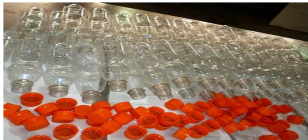
Figura N° 47: Envases de plástico rígido (botellas plásticas de PET-PCR grado alimentario post consumo) transparente con tapa rosca de plástico.
