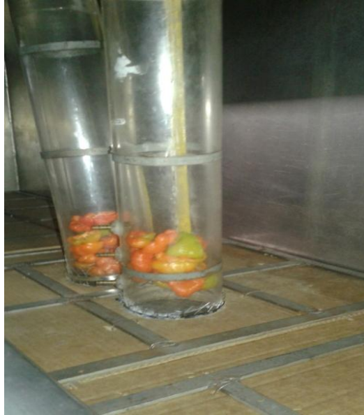
Figura N° 14. Fluidización de las muestras de Capsicum annuum en el secador.
