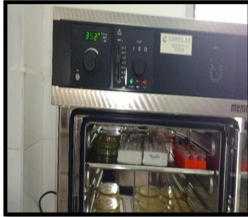
Incubación de los microtubos con las diluciones del extracto y el inóculo bacteriano, control positivo, control negativo a 35°C por 24 horas.
