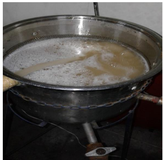
Marmita con la solución azucarada empezando la el proceso de deshidratación osmótica
