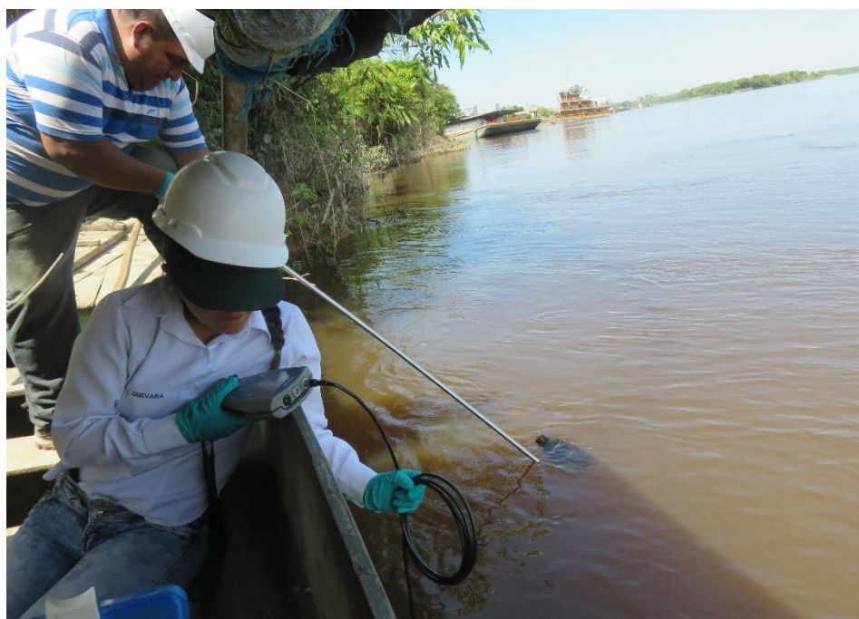
Foto N° 37: Midiendo parámetros In situ y tomando muestras de agua superficial en el Río Nanay.
