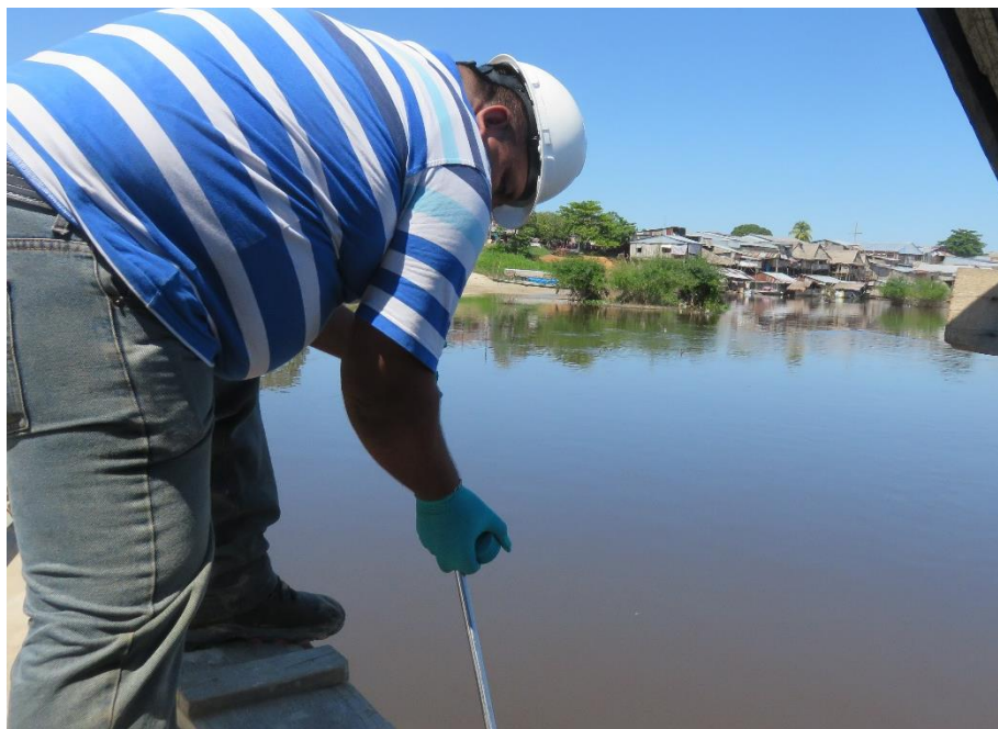
Foto N° 05: Tomando muestras de agua superficial de la Laguna Moronacocha
