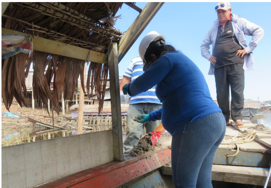
Foto N° 07: Tomando muestras de sedimentos en la Laguna Moronacochoa.
