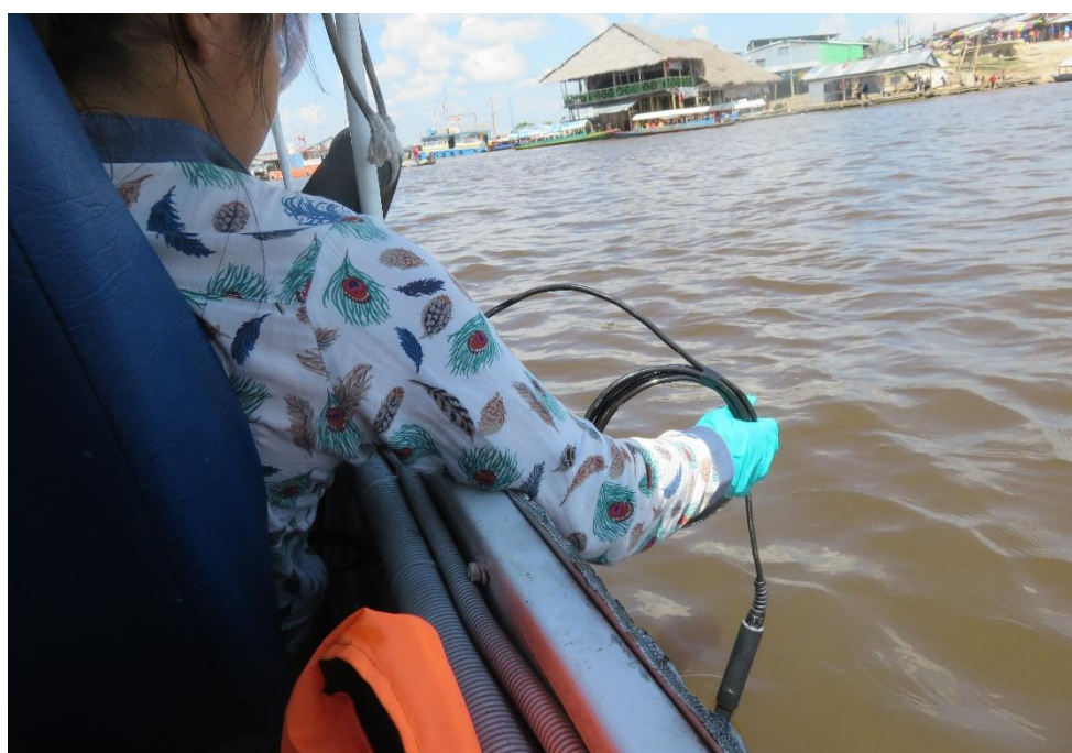
Foto N° 41: Midiendo parámetros Insitu y tomando muestras de agua superficial en el Río Nanay.
