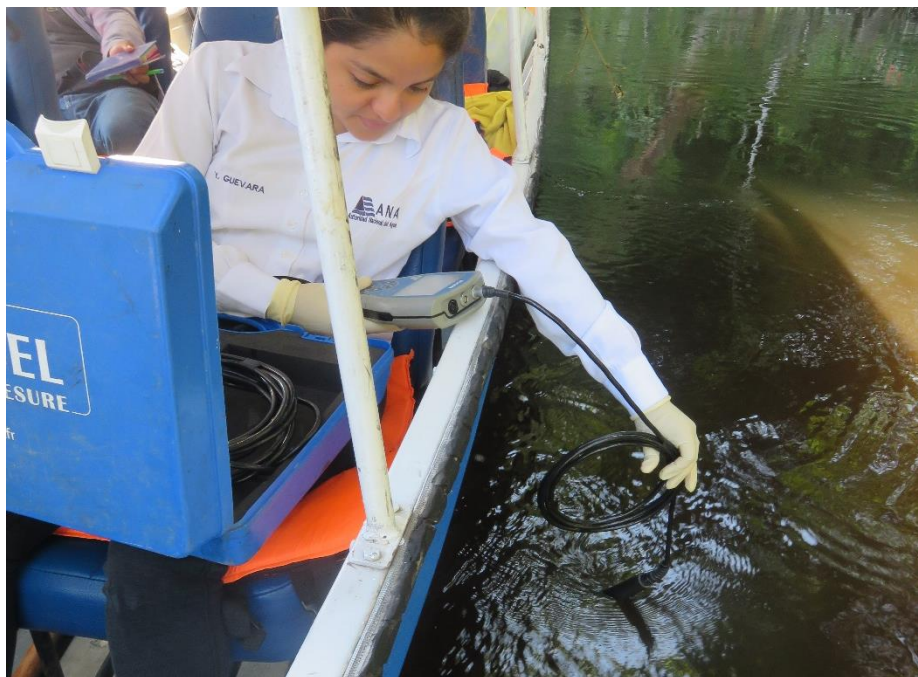
Foto N° 47: Medición de Parámetro Insitu en el Río Nanay.
