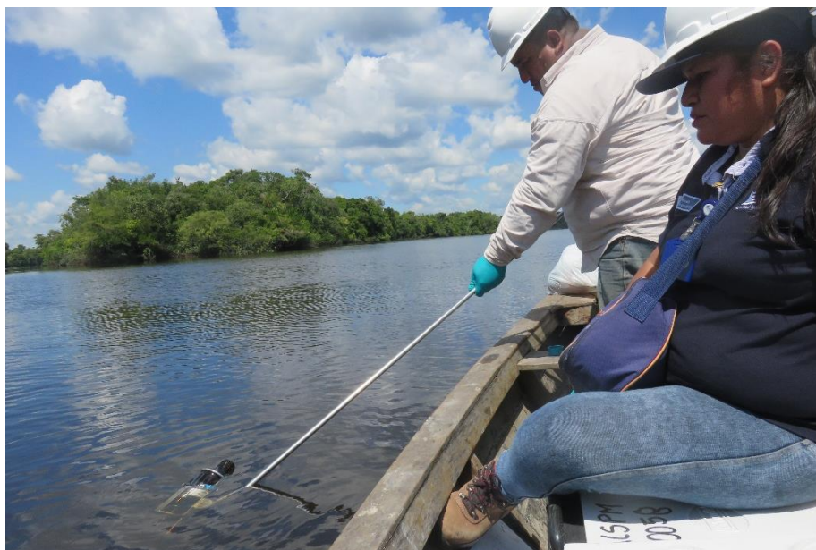
Foto N° 24: Tomando muestras de agua superficial en la Laguna Llanchama.
