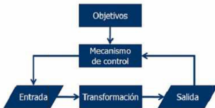
Sistema con realimentación
