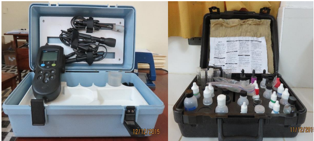
Ilustración 9. Equipos limnológicos para el registro de parámetros físicos y químicos en el proceso de reproducción inducida de sábalo cola roja Brycon cephalus .
