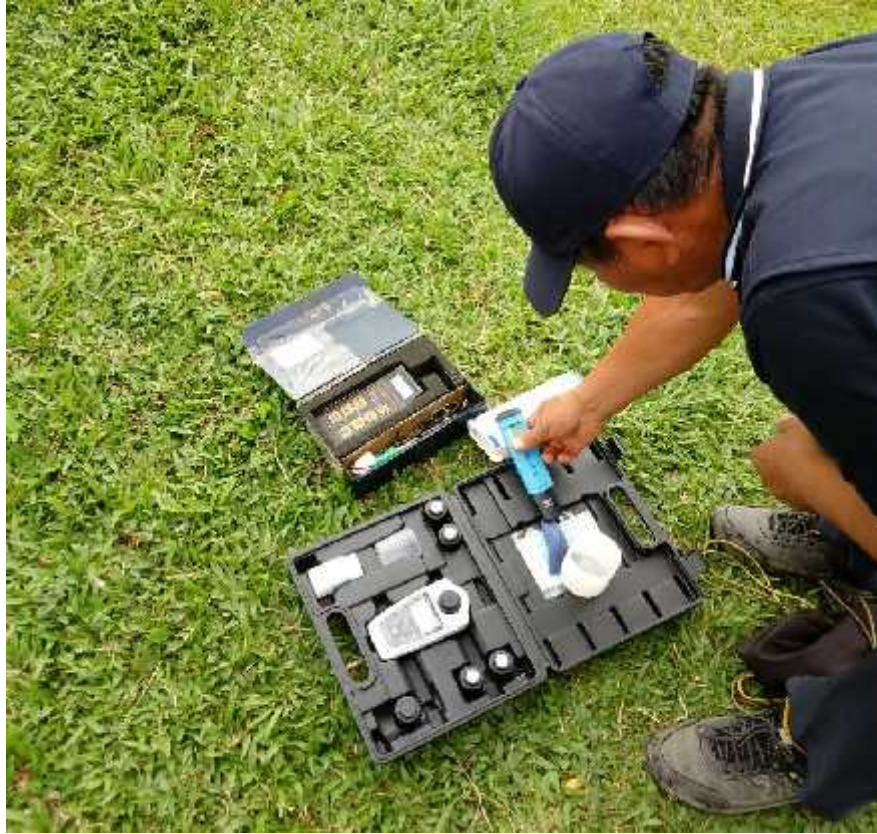
Foto 10. Equipos utilizados para la medición de los parámetros físico-químicos del agua.
