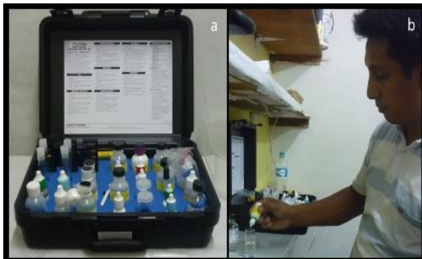
Foto 13. Equipo La Motte AQ-2 (a) y análisis de p H del agua (b).
