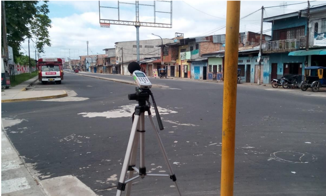
P. 32. Av. 28 de Julio/Av. Navarro Cauper, Zona Residencial (PDU), Zona Residencial (ECA-Ruido)-Punchana. 81.3 dB.
