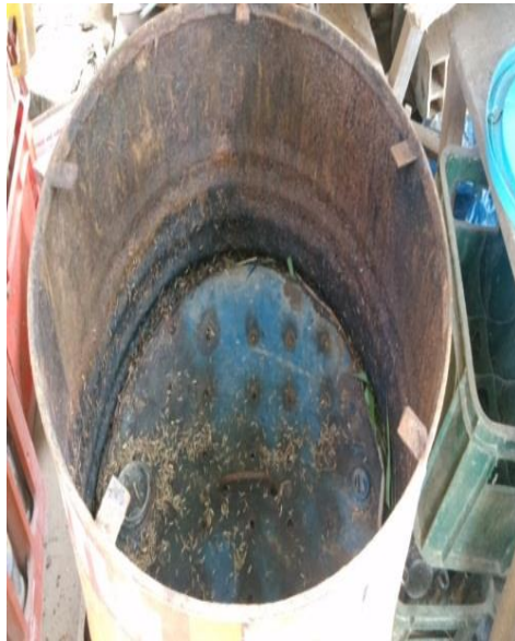
Foto 13: la cascarilla de arroz va perdiendo volumen efecto de que la pirolisis al convertirlo en carbón expulsa el agua que la cascarilla posee.
