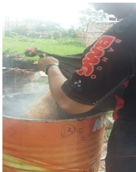
Foto 06: depositando la cascarilla de arroz al interior del horno
