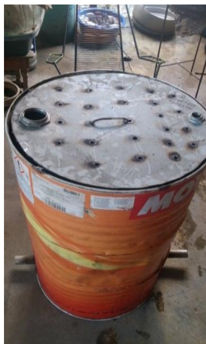
Foto 02: horno con la estructura completa.
