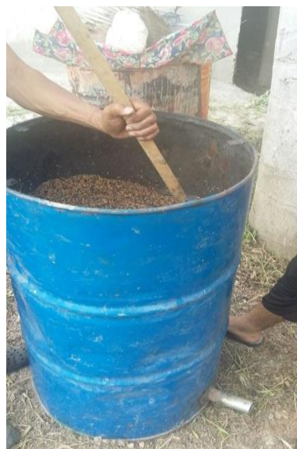
Foto 08: removiendo la cascarilla de arroz, realizarlo para obtener homogeneidad en la producción.
