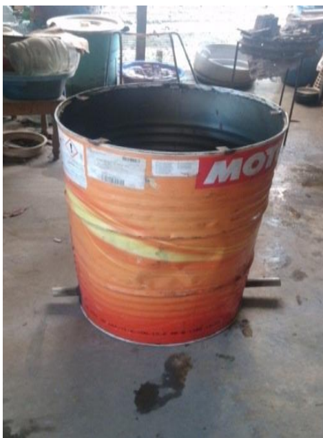
Foto 01: estructura del horno en el cual se procesó la cascarilla de arroz
