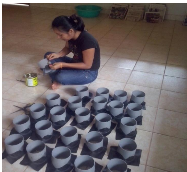
Figura 15. Vista del proceso de pegado en llantas ya cortas a los tubos para poder colocar en el fuste con ayuda de las cintas plásticas.
