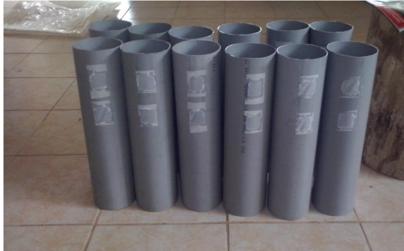
Figura 16. Tubos de 40 cm con ventanas, listos para la instalación de los componentes del suelo.
