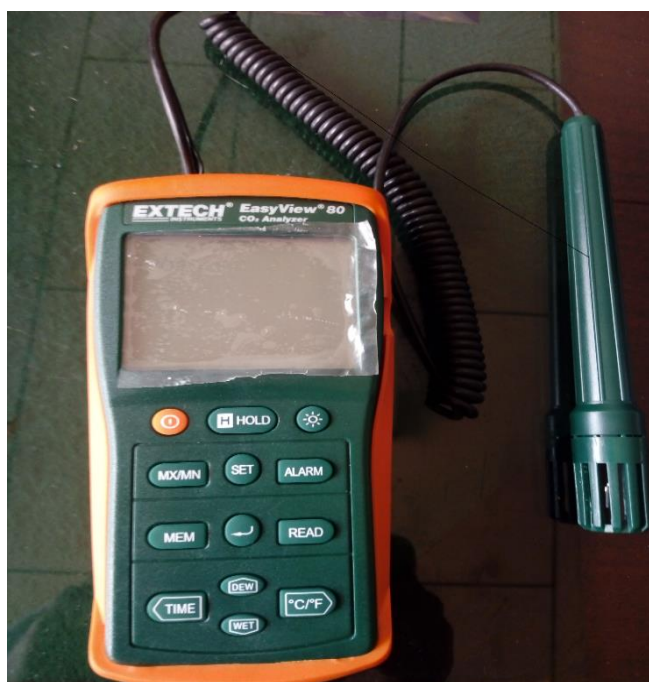
Foto 5. Multiparámetro utilizado en campo. EXTECH Easy View 80. CO 2 Analyzer
