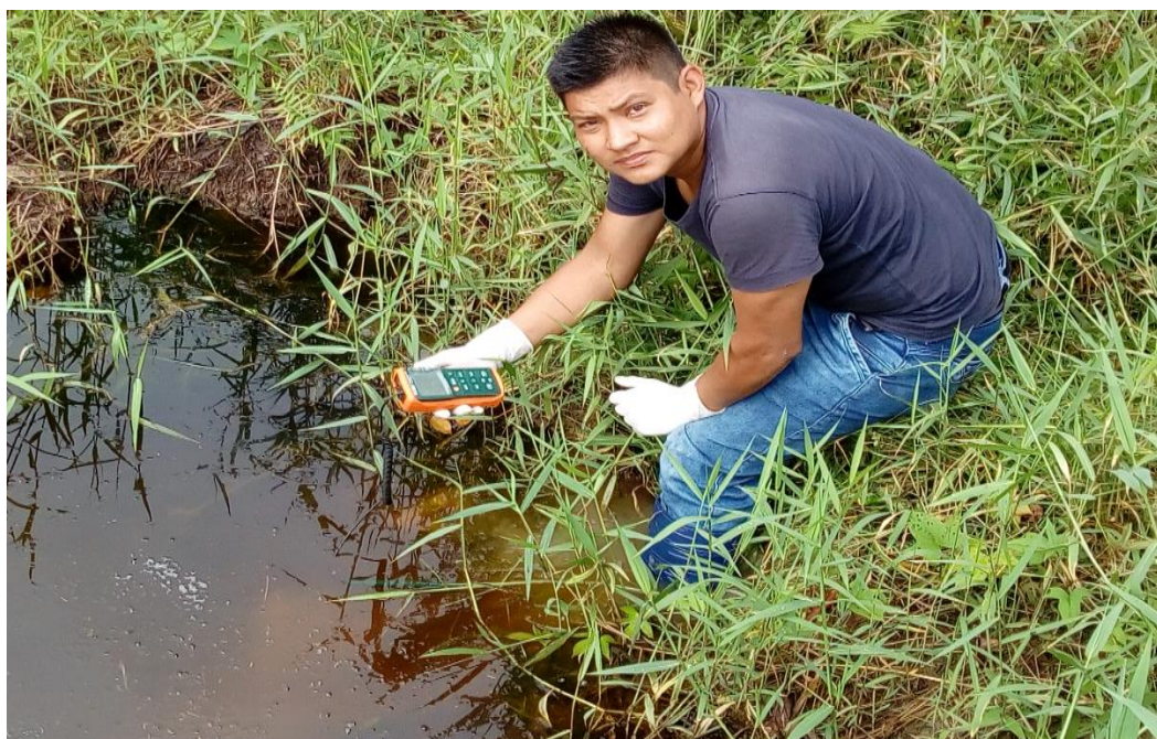
Foto 6. Monitoreo de parámetros físicos con Multiparámetro EXTECH Easy View 80. CO 2 Analyzer.
