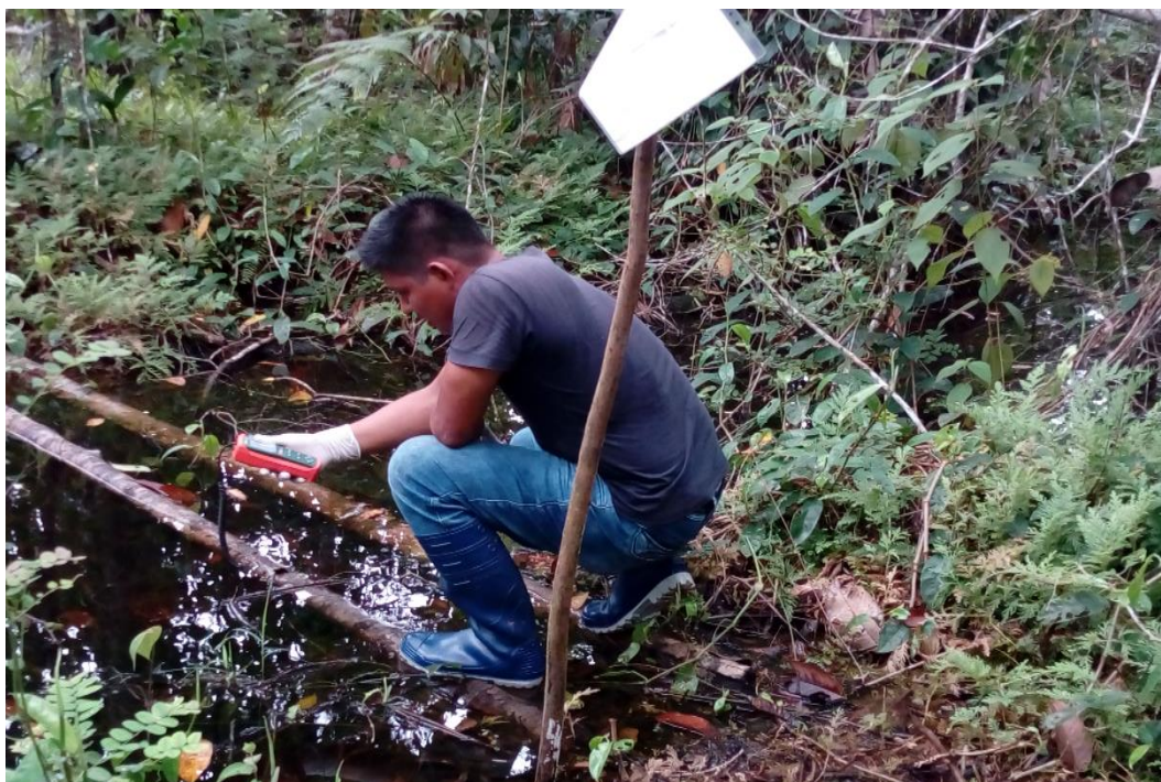
Foto 8. Monitoreo de parámetros físicos en CR-L1 con Multiparámetro EXTEC Easy View 80. CO 2 Analyzer.
