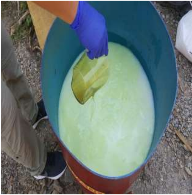
Figura 08. Preparación de la solución preservadora
