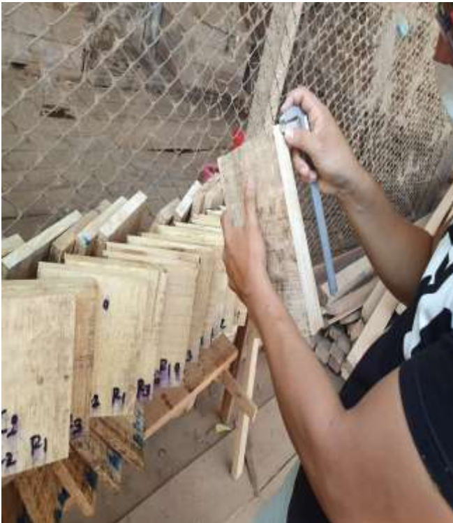
Figura 10. Medición de la penetración
