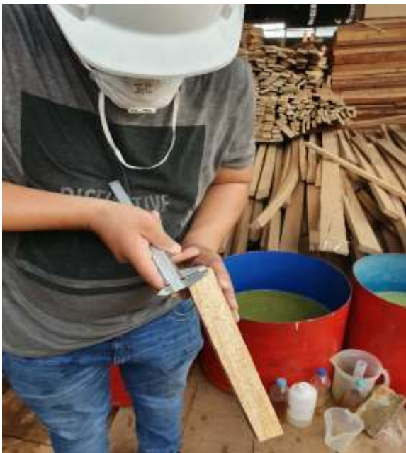
Figura 10. Medición de la penetración
