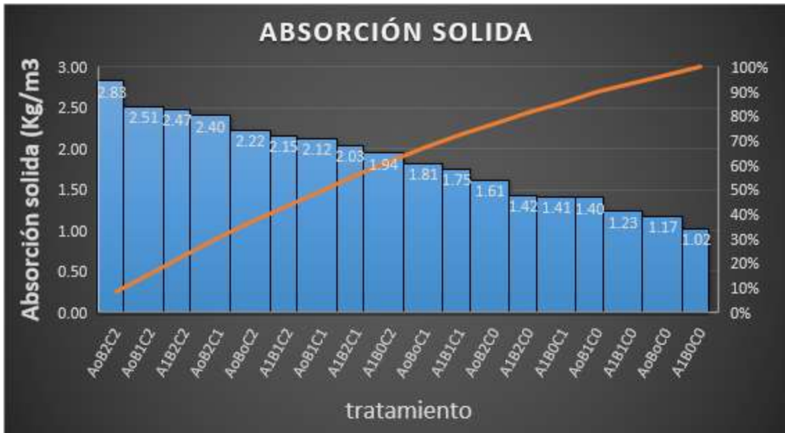
Fig. 01. Absorción Sólida (Kg/m 3 ), de la Inmersión prolongada para los tratamientos.
